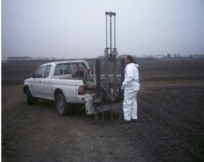
*Esecuzione di indagine geotecnica mediante penetrometro statico*
