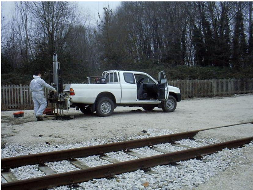
*Esecuzione di indagine geotecnica mediante penetrometro statico in ambito ferroviario*
